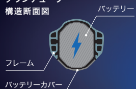
ダウンチューブ 構造断面図
