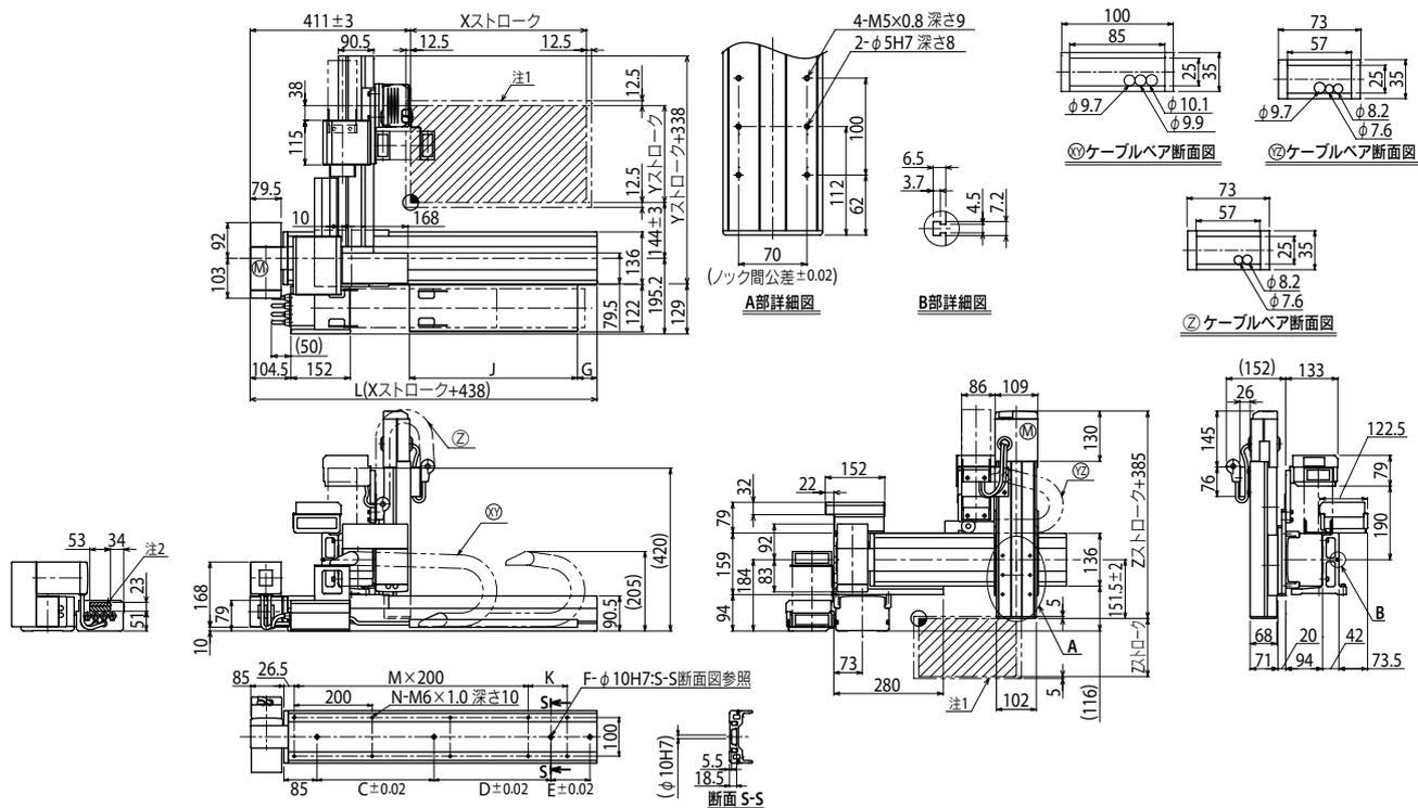
注1. 原点復帰時の移動範囲及びメカストップによる停止位置です。 注2. 斜線部位置は、ユーザ用のケーブル取り出し口を示すものです。
