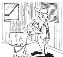
6. 発電機にカバーを掛け、室内で湿気が少なく換気の良い場所に格納します。
