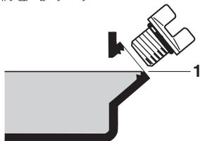
6. 発電機本体を傾けてエンジンオイルを抜きます。
