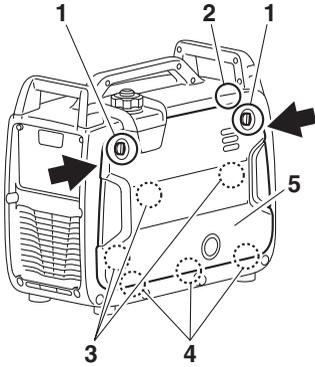
2. 背面にある 2 個のパネル取り外し用のスクリュを反時計回りに約 10 回転程回しゆるめます。パネル上部のボッチ部を手前に引き隙間を作り、スクリュ横（矢印部分）に手を入れパネル全体を手前に引き、取り外します。
