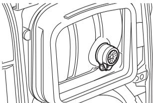
5. マフラーワイヤネットとマフラーキャップを取り付けて、マフラーキャップボルトを締め付けます。
