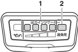
4. 電圧計のセグメントが適正電圧範囲内を示しているか確認します。
