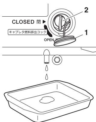
4. キャブレタ燃料排出コックを“OPEN 開”にして、キャブレタから燃料を抜きます。
