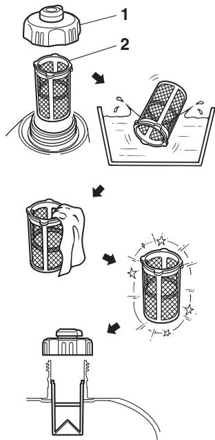
2. 燃料タンクキャップおよびストレーナを取り外します。
