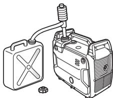
2. 燃料タンクキャップおよびストレーナを取り外し、市販のポンプを使用して燃料（自動車用レギュラーガソリン）を抜きます。なお、電動式ポンプは使用しないでください。
