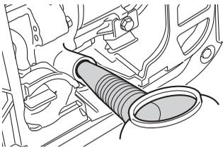
4. エンジンオイルを規定量（注入口の口元まで）給油します。
