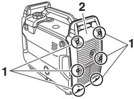
2. ボルトを外し、カバーを外側に引いて取り外します。
