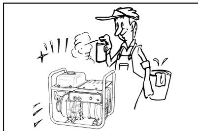
6. 発電機にカバーを掛け、室内で湿気が少なく換気の良い場所に保管します。
