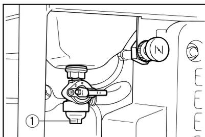
3. 燃料コックのレバーをOFF（閉）からON（開）にして完全に燃料タンク内の燃料を抜きます。
