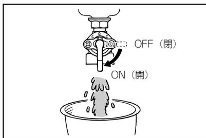
4. キャブレタのドレンスクリュ①をドライバ②で弛めて燃料を抜きます。
