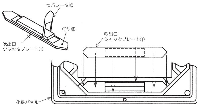
2) 項目1.の作業が終了しましたら、選択した3方向吹出口の斜線部の板を、下図要領で化粧パネル裏側より取外します。
