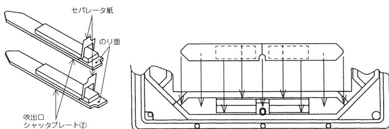
2) 項目1.の作業が終了しましたら、下記に示すように該当する斜線部の板を、下図要領で化粧パネル裏側より取外します。
