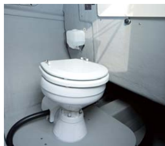
トイレルーム・電動マリントイレ(OP)
