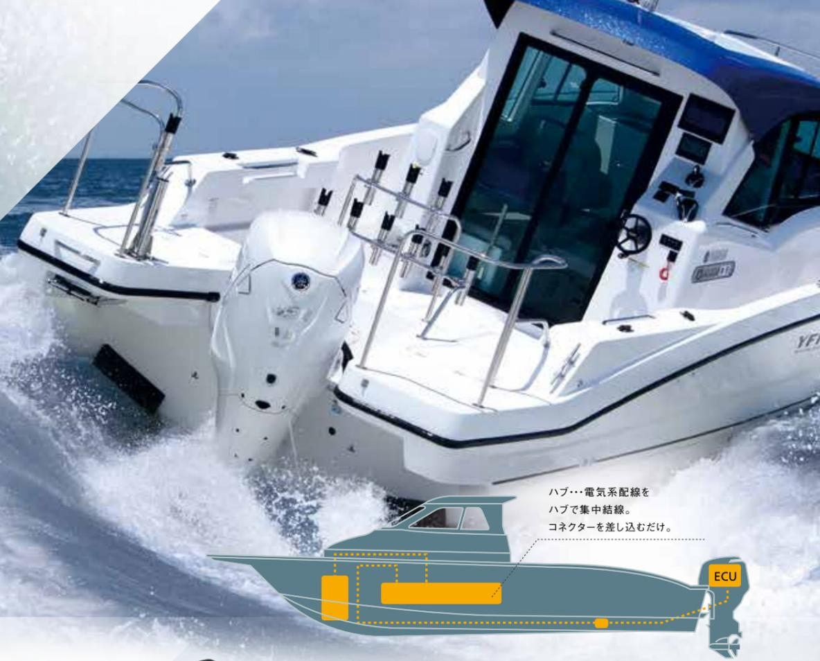
ハブ...電気系配線をハブで集中結線。コネクターを差し込むだけ。
