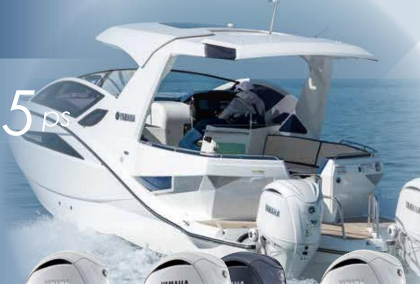
4ストローク300~225馬力モデルはハイパワーとコンパクト性を両立させた先進のシリーズです。船外機としては世界で初めて「スリーブレスシリンダー」を採用したほか、ボトムカウリングに軽量の樹脂素材を採用するなど徹底した軽量・コンパクト設計を実現。また、ECM（エンジンコントロールモジュール）や「可変カムシャフトタイミング」による優れた燃焼効率と出力特性により、卓越したスピード性能と燃費性能を実現しました。
