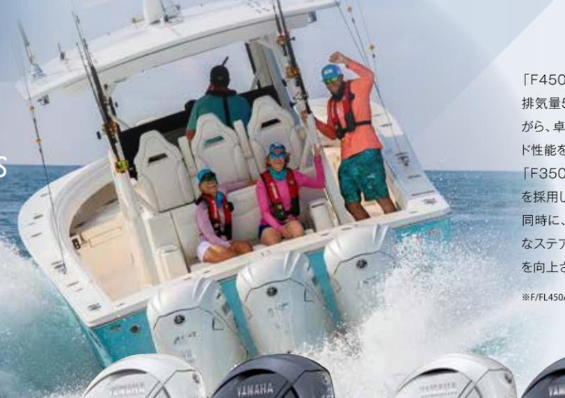
「F450A」は、「F425A」に搭載され、市場から高い評価を得ているV型8気筒、排気量5,559cm<sup>3</sup>のエンジンをベースに新設計した船外機です。重量を抑えながら、卓越したトルクとパワーを発揮し、ボートに最高レベルの加速性能とスピード性能を提供します。
