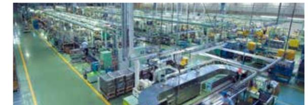
船外機の4ストローク化や大型化の進展に伴い、2008年に船外機工場を静岡県袋井市に設立しました。これにより、物流・安全面の充実を図るとともに、塗装工程のロボット化やモジュール生産方式など新たな工法を導入して生産性と品質の更なる向上を図っています。また、環境面では自然採光や水循環システムなどを導入し、地球環境にやさしいものづくりを行い、2022年12月には船外機累計生産台数1,300万台を達成しました。
