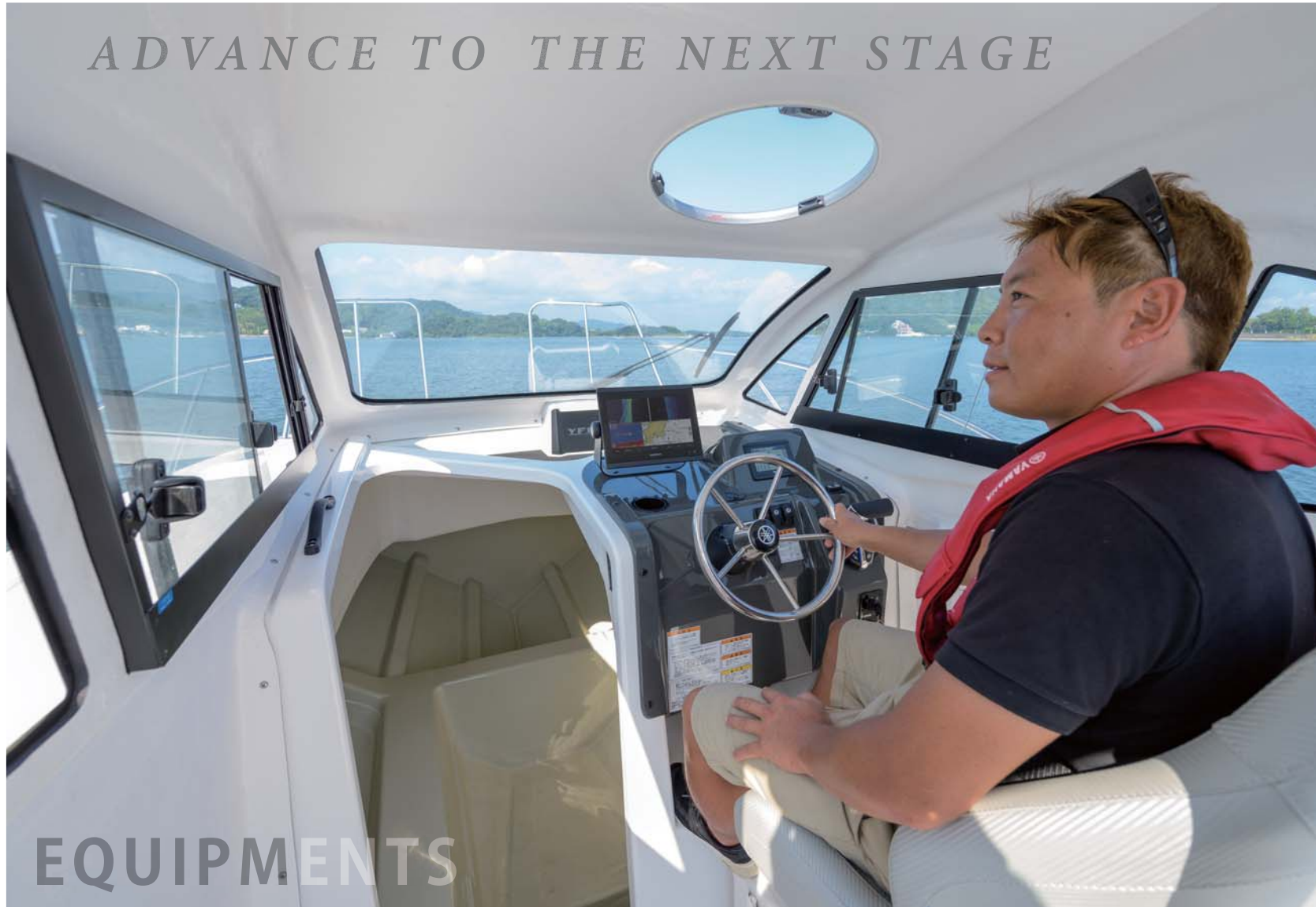
コックピットには、タッチスクリーン5インチカラーディスプレイ「CL5」をビルトイン、アングラー各々の最適なドライビングポジションと良好な視界を確保しました。また、フロントウィンドウ下をGPS魚探やレーダーの設置スペースとし、自由なレイアウトを可能としました。
