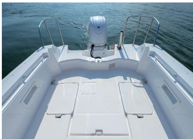
スターンデッキ スターンデッキをフルフラットにし、広いスペースを確保。スターンレール(純正OP)を装着すればトランサムデッキでの釣りも可能です。またモーターウェルレール(用品OP)を装着すればロッドホルダーの取り付けや航走時の姿勢保持に有効です。
