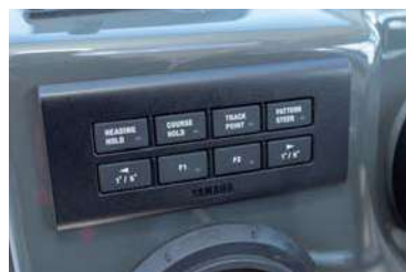
オートパイロットスイッチパネル
