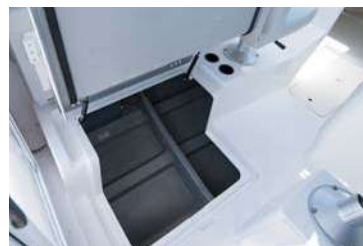
フロアハッチ(パッセンジャーシート下)
