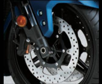
\*車輪に付けられたセンサーがスリップを検知すると、ブレーキを制御して車輪のロックを抑制します。制動距離を短くしたり、転倒を回避するシステムではありません。コーナー等の手前では十分に減速し、コーナリング中の急制動を避けてください。
