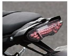
リア周りは、フロント周り同様に各ボルトが露出するデザインで、サイドバッグ等のオプションパーツの装着に配慮した。またLEDフランジャー、LEDライセンスプレートランプなどに加え、メーターパネル左側には12V・DCジャックを装備している。
