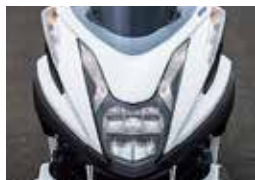
リフレクター構造をアップデートし、照射範囲が拡大したLEDヘッドランプ *4
