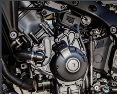
からスロットルバルブ側に取付け位置を変更。噴射はバルブ傘裏方向とし、燃料霧化促進と吸気ポートへの燃料粒子付着量を抑え、優れた燃焼効率を達成。またスロットルバルブの駆動には、YCC-T(電子制御スロットル)を採用している。
