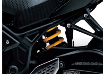
イエロースプリングの 専用リアサスペンション
