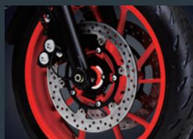
\*車輪に付けられたセンサーがスリップを検知すると、ブレーキを制御して車輪のロックを抑制します。制動距離を短くしたり、転倒を回避するシステムではありません。コーナー等の手前では十分に減速し、コーナリング中の急制動を避けてください。
