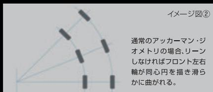
従来のLMW機構でリーンさせると、リーン具合によりフロント左右輪の向きにわずかな差異が生じます。ただリーン角が浅いときは、ショックアブソーバーやタイヤが緩衝機能を果たし、その差異をライダーが感じることはなく、走行性・操縦性への影響もありません。ただし、たとえば約45度のリーンを求めると、一般的なアッカーマン・ジオメトリだけでは走行バランスに影響が出ることがあります。リーンに伴いタイロッドが傾斜するので、実質上のタイロッド長が変わり、フロント左右輪の向きに差が生じ左右輪は別方向を向いてしまいます。(図③)
