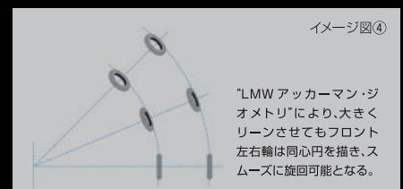
万一、直進中に急停止した場合でも前輪がロックしにくく、前輪ロックによる転倒リスクを低減します。また、旋回中にやむを得ずフロントブレーキをかけた場合でも、フロント二輪であることから車両が起き上がる挙動が穏やかで、コントロールしやすいものになっています。
