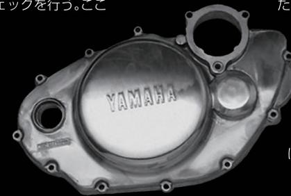
を変えてもバフが届かない部分ができる。そこで、その細部を下磨きするために小回りの利くリユーターを使用する。細かいところだけに、磨き残しを作らず、しかも均一に磨くには熟練の技を必要とする。リユーター処理が終わったら、再びグラインダーとバフを使い、下磨きを進めていく。どの番手のバフを使って、どの程度まで仕上げるかは、その日の天候や鑄造されたケースカバーのコンディションによっても変わってくる。それを見極めるのは、やはり長年の経験によって培われた人間の目と手の感覚だ。最終磨きの工程では、通称“サイザル”と“ブリーツ”の2種類の磨きを、大小それぞれのバフで行うため、結果4種類の磨きが行われる。大小2種類のバフを使うのは、より細かい場所にもバフを行き届かせるため。この工程に入ると、ケースカバーはいきなり輝きを増し、最終的には鏡のような仕上がりとなる。しかし、ただ強く長くバフを当てれば輝きが増すのではない。バフにケースを当てては確認する、という作業が延々と繰り返されるのである。
