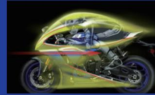
YZF-R1を構成するすべての要素には、意味と機能がある。デザインも同様だ。高出力エンジンを搭載するYZF-R1であればこそ、そのデザインはライダーとマシンの一体感を高め、自在なマシンコントロールを実現するために存在する。ライダーと接する部分はエルゴノミクスを考慮しながら入念に作り込み。前後左右にスムーズに体を動かせるシームレスな造形としている。さらにカウルは新デザインを採用。空気抵抗特性を従来モデル\*比で5.3%向上。アンダーカウルの形状と相まって、フロントからリアにかけてスムーズに走行風をいなししながら、水平基調によるスピード感も強調する。無駄なく引き締まったアスリートの筋肉を思わせる各部のデザインディテールが機能美を醸し出し、ヤマハデザインの頂点をアピールする。
