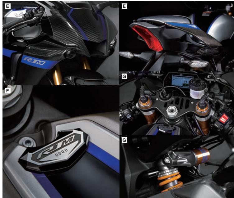
E:軽量かつ高品質感を醸し出すライカーボン製アッパーカウル／テールカウル F:所有感を満たすプレミアムなシリアルナンバー入りエンブレム G:走行状況に応じて伸側・圧側減衰力を統合制御するオーリンズ製電子制御サスペンションを前後に搭載。フロントサスペンションにはガスシリンダーを装備
