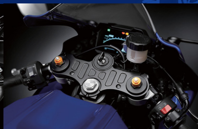
スポーツ走行に適したライディングポジションをもたらす セパレート型ハンドル ※写真は海外で撮影されたもので、 仕様が国内とは一部異なります。
