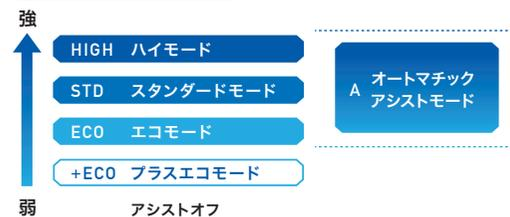
ライディングに集中できるオートマッチクアシストモードを搭載。走行状況に応じて、ライダーの要求にシンクロするアシストをHIGH / STD / ECO の3モードから自動選択し、最適なアシストを提供する。
