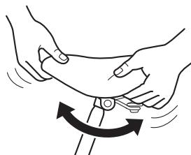
**シートバンドの締め付けボルトを締め付けすぎない**
