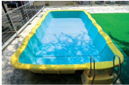
旭ヶ丘幼稚園 屋外プール ユニットプールきらきら プールサイズ/3m×6m 水深/0.55m 重量/314kg 容量/8.8t 水面積/17.3㎡
