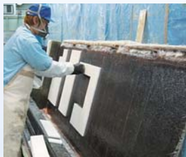
ガラス繊維とポリエステル樹脂を積層。ガラス繊維で硬質発泡体を積み込み、作業を繰り返す。
