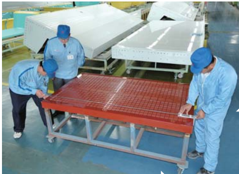
フロアの型をチェックする品質保証グループのスタッフ。この型の精度がそのままユニットの品質に反映される。安定した品質のユニット製造により、現場の組立ロスも無くなるのだ。
