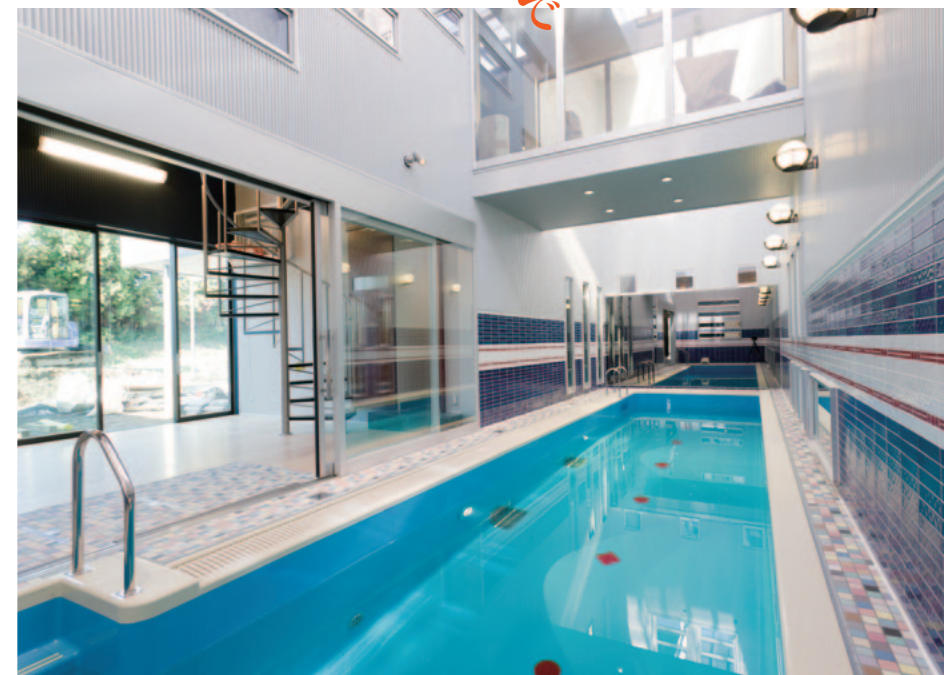
M氏邸 【プールサイズ:10m×2.3m 水深:1.25m】 入水階段 水中照明×2
