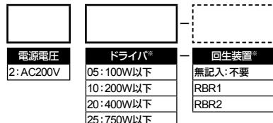
※ ドライバ選択及び回生装置の選択はロボットの機種によって決まっております。
