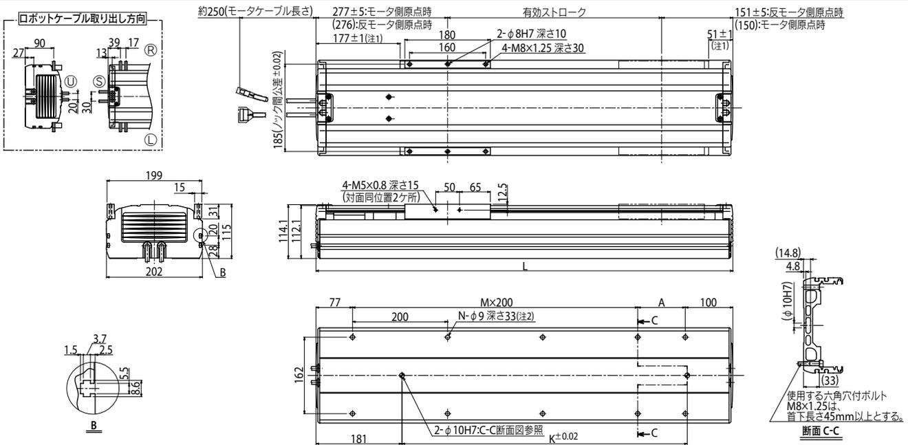
注1. 両端からのメカストップによる停止位置です。注2. 取り付けの際、本体内部にワッシャ、スプリングワッシャ等のご使用はできません。注3. モーターケーブルの最小曲げ半径はR50です。
