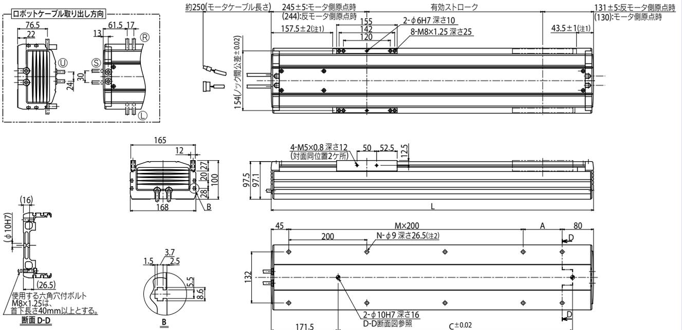
注1. 両端からのメカストップによる停止位置です。 注2. 取り付けの際、本体内部にワッシャ、スプリングワッシャ等のご使用はできません。 注3. モータケーブルの最小曲げ半径はR50です。
