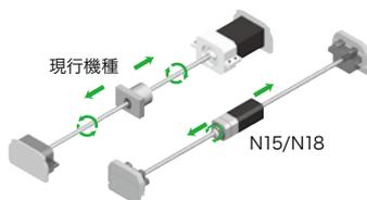
中空モータをボールネジのナットに連結し、ネジ軸を固定したままナットを回転させて移動する構造。
