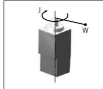
※ R5のシャフトに取り付けるツールやワークの質量が Wkgのとき、その慣性モーメントの値Jが上記表の値より小さくなるようにしてください。大きくなる場合は、上表で相当するWの値を入力してください(例:Wが3kgでJが0.48kgfcm<sup>2</sup>のとき、入力する値は4kg)。上記の質量パラメータはコントローラに入力する値であり、この値により自動的に加速度が設定されます。
