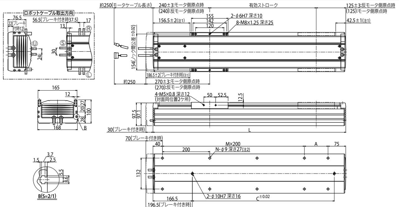
注1. 両端からのメカストッパによる停止位置です。注2. 取り付けの際、本体内部にワッシャ、スプリングワッシャ等のご使用はできません。注3. モータケーブルの最小曲げ半径はR50です。
