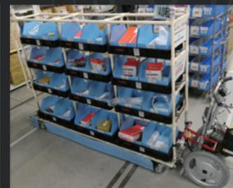
扱う商品が違う工場でそれぞれの台車に合わせたアシストユニットを取り付け200kg~Max320kgまで搬送実績あり!
