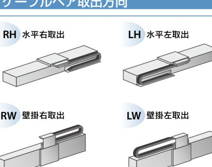
※ 設置は必ずケーブルペア取出方向図や各仕様図通りの方向で行ってください。それ以外の取り付けは、不具合の原因になりますので御注意ください。なお取出方向が上記標準以外のご要件に対しては、特注にて対応させていただいておりますので弊社までお問い合わせください。
