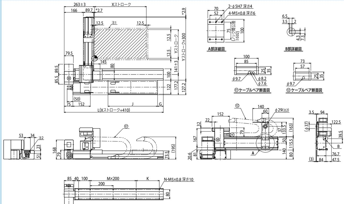
注1. 原点復帰時の移動範囲及びメカストッパによる停止位置です。 注2. 斜線部位置は、ユーザ用のケーブル取り出し口を示すものです。 注3. 図中\*の寸法はネジ高さです。
