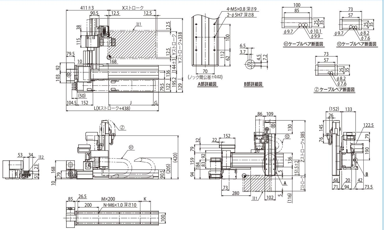
注1. 原点復帰時の移動範囲及びメカストッパによる停止位置です。 注2. 斜線部位置は、ユーザ用のケーブル取り出し口を示すものです。
