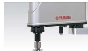
先端へのツール取付けが容易なツールフランジオプション
