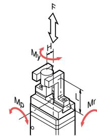
・ガイド部の許容荷重、許容モーメントが表の値以下になるように、フィンガを取り付けてください。
