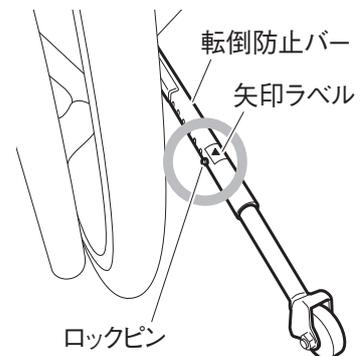
ロックピンの先端が出ていない場合は、“カチッ”とロックピンが出た音がするまで穴の位置を調整してください。
