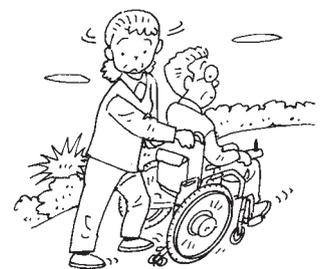
以下の操作は電源を切り、クラッチレバーを手押し側にして行ってください。
