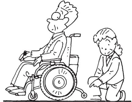
補助輪が上がっている場合は必ず補助輪を下げます。
